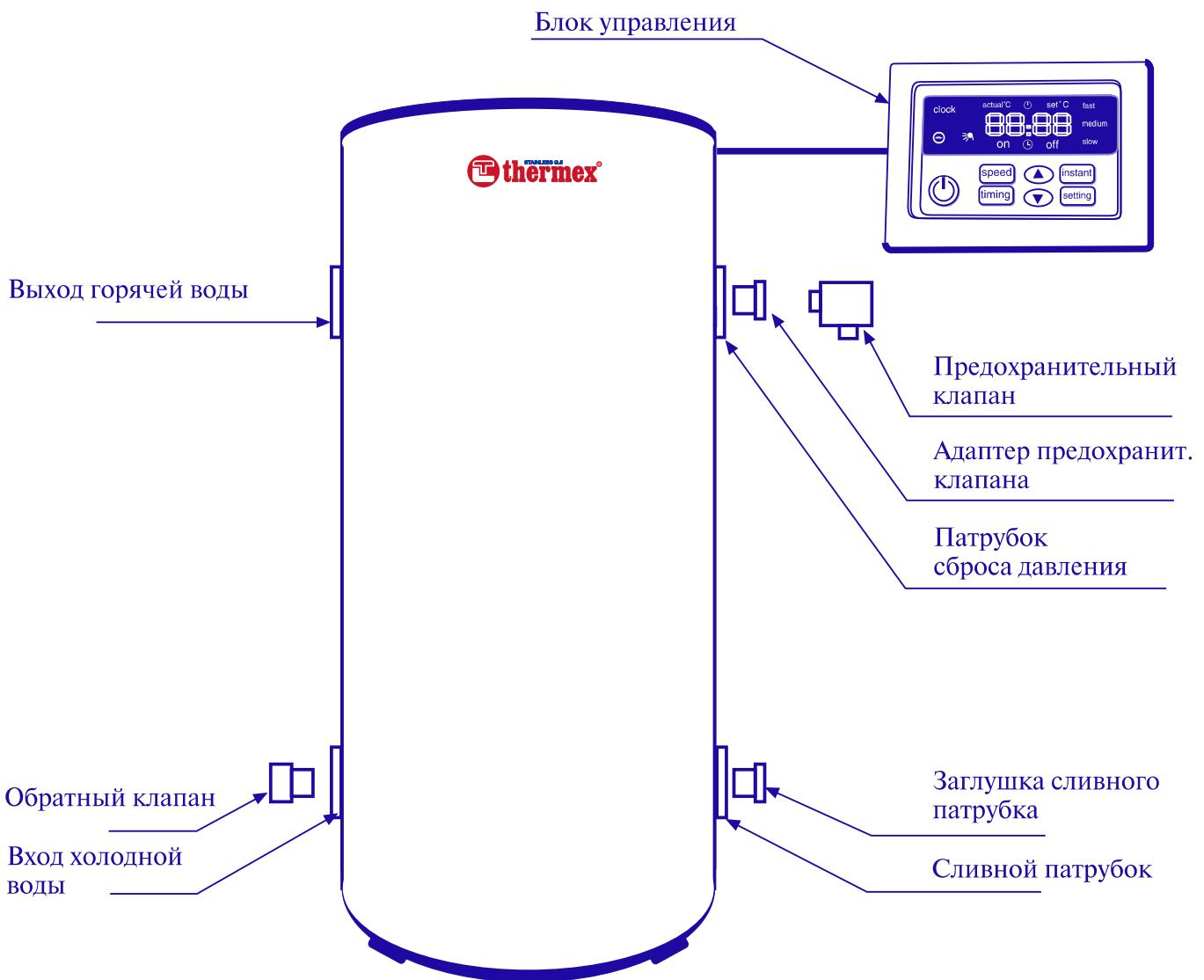
Рис. 3. Схема подключений.
