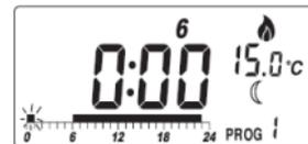
III. Нажимаем **Prog # 5** раз для изменения номера программы с **PROG 1** на **PROG 6**:
