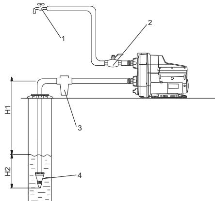
Рис. 2. Подача воды из колодца/скважины
