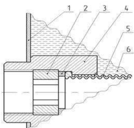
***Рисунок 2. Резьбовой фитинг проточного водонагревателя***
