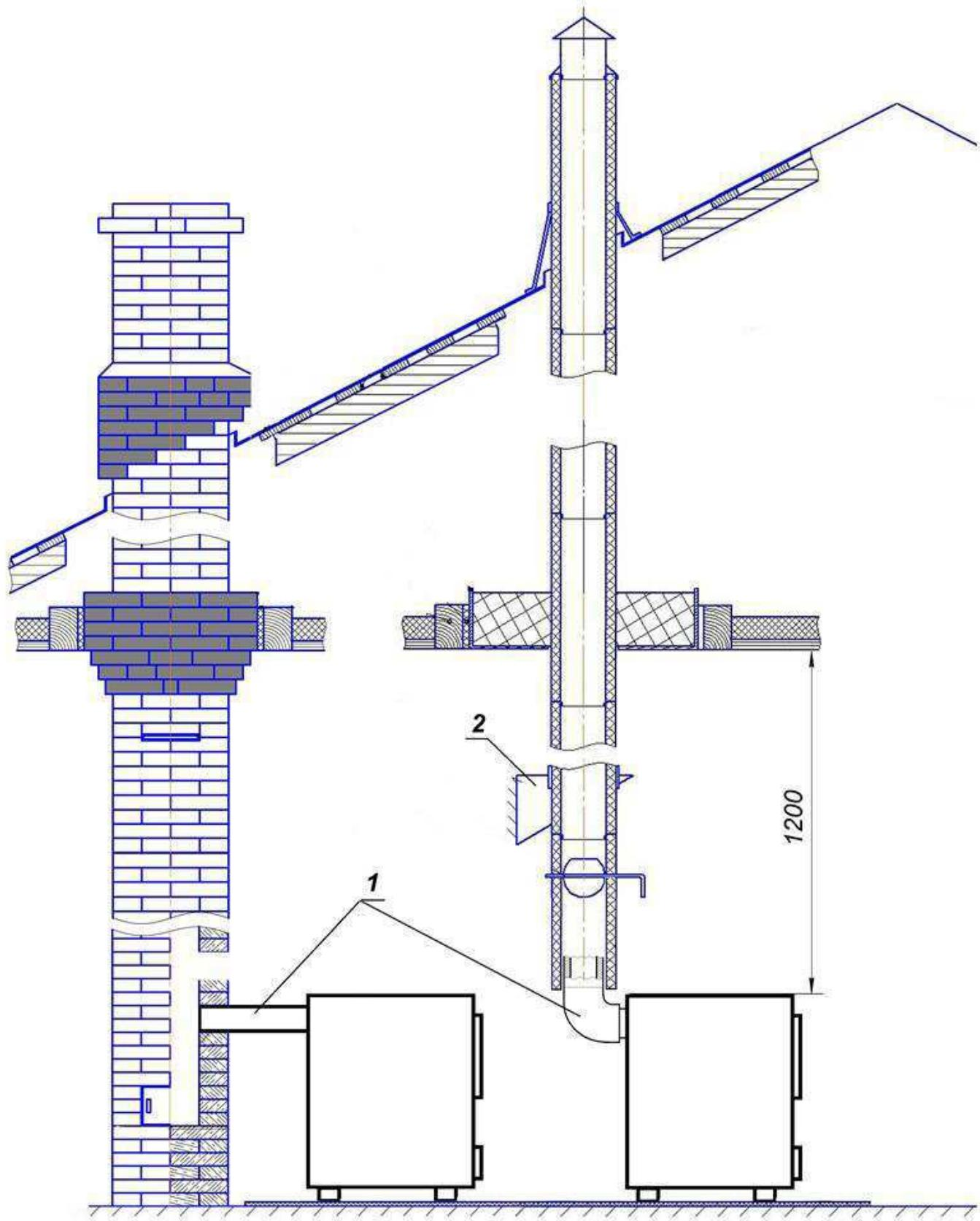
*Рисунок 3. Схема установки дымовой трубы*
