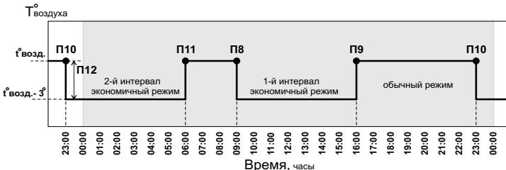
**Рис.4 График температуры воздуха в помещении для Режима 1.**
