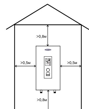
Рис.4 Схема установки миникотельной
