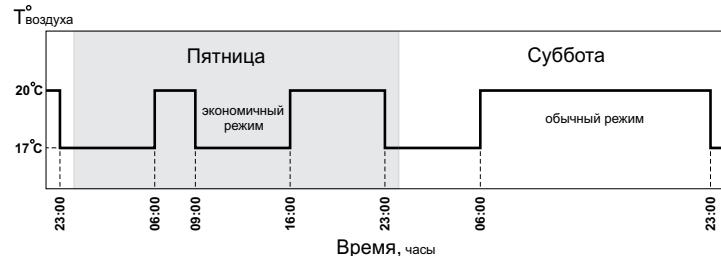
**Рис.6 График температуры воздуха в помещении для Режима 3.**
