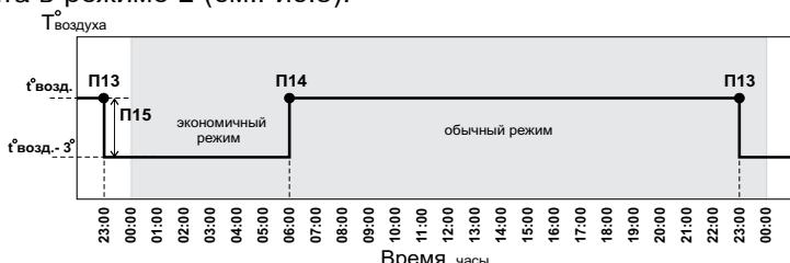
**Рис.5 График температуры воздуха в помещении для Режима 2.**
