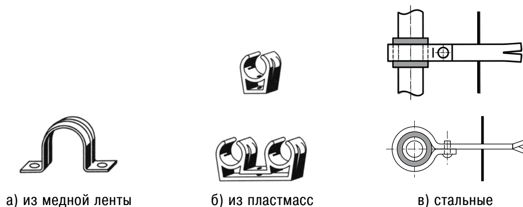
Рис. 6.4. Опоры для крепления медных трубопроводов.
